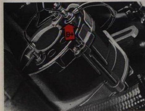
Ledning B+ på generatoren
