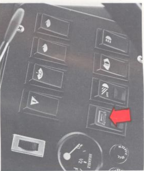
Bild 23. Strömställare för batterivärmare
