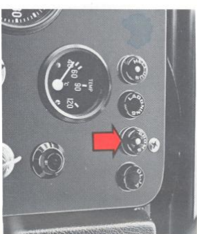
Bild 36. Kontrollampa för parkebröms och bromskretsar
