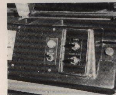
Bild 15. Strömställare för sirén och lyktor med roterande sken på ambulansterrängbil 1315
