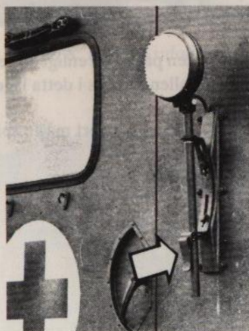
Bild 13. Arbetsstrålkastare på sjuktransporthytt 532B
