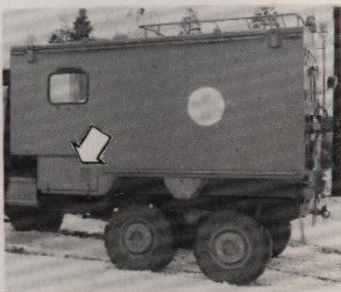
Bild 4. Lucka för värmearrättning
