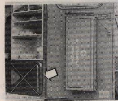
Bild 7. Mörkläggningskivor, placering då de inte används
